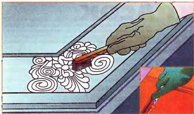
Рис. 5. Рельефные украшения, профили после высыхания смывки аккуратно обрабатывают мягкой металлической щёткой. Краску на кромках и в пазах удаляют лезвием ножа, лезвием отвёртки и другими инструментами с острой кромкой. Работают в резиновых перчатках.
