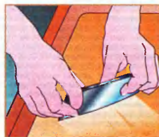
Рис. 9. Применение цикли с изогнутым лезвием. Краску удаляют одной из заточенных кромок цикли.
