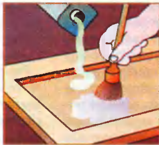
Рис. 1. Смывку наносят на обрабатываемую поверхность и равномерно распределяют кистью.
