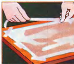
Рис. 2. Чтобы замедлить процесс высыхания активных веществ в смывке, поверхности деталей укрывают плёнкой.
