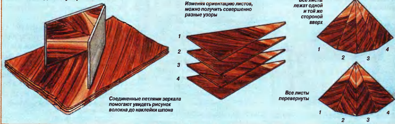
Рис. 1. Создание узора из шпона.
