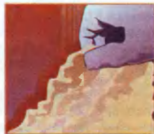
Рис. 4. В некоторых случаях после выдержки в течение нескольких часов смывку просто снимают с основы.
